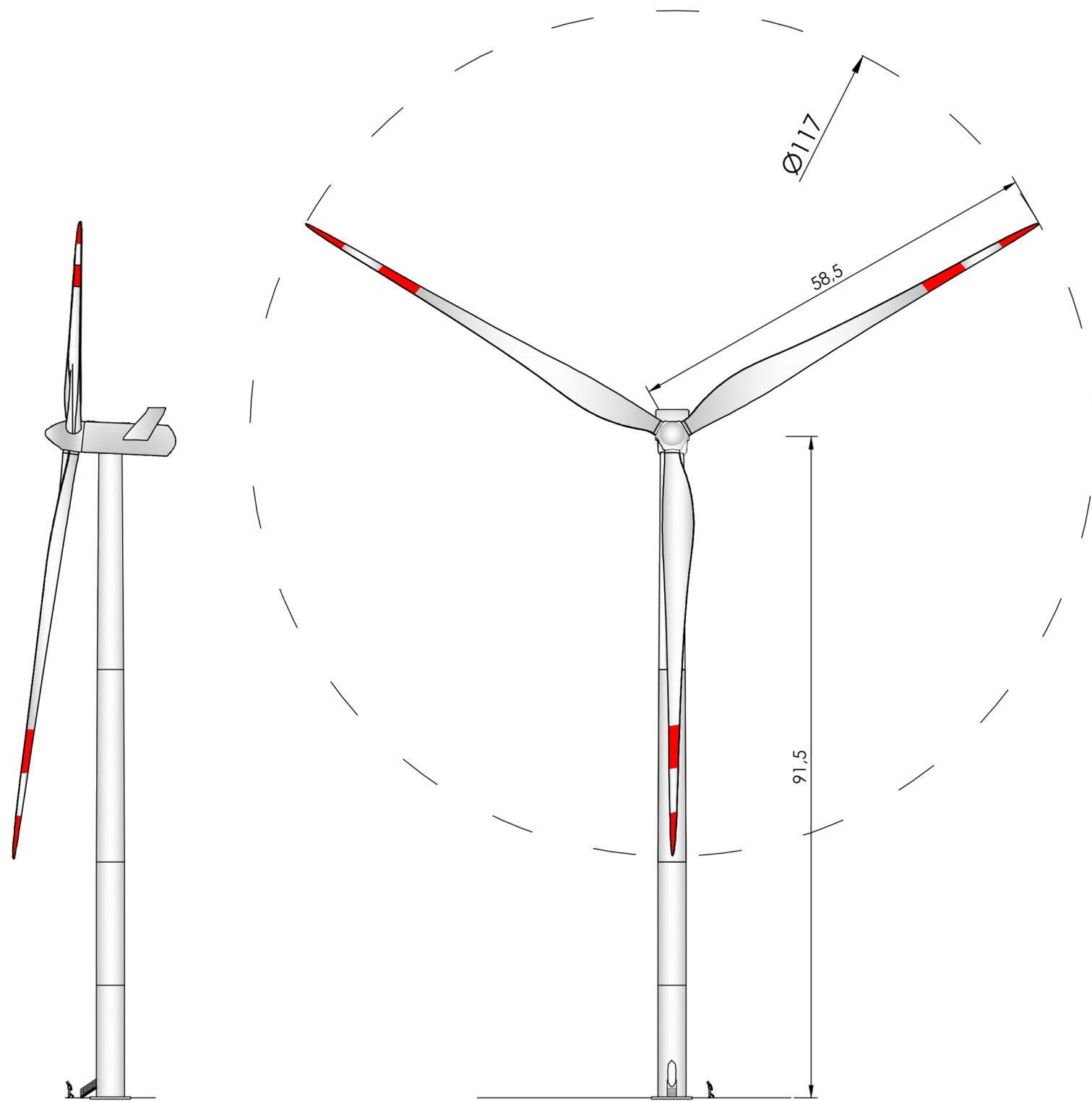
PROSPETTO FRONTALE E LATERALE AEROGENERATORE VESTAS V117 3,45 MW con D = 117 m e Hmozzo = 91,5 m (Scala 1:500)
