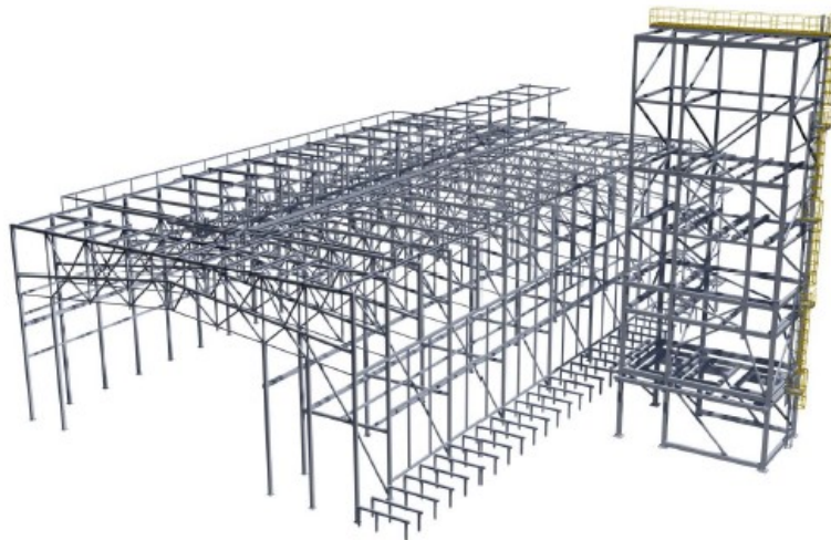
Figura 9: Strutture vano motori e camini
