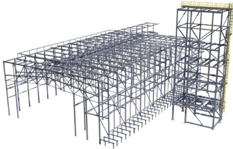
Figura 2: Strutture vano motori e camini
