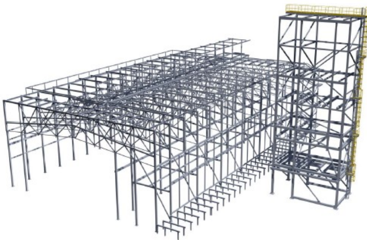
Figura 8: Strutture vano motori e camini
