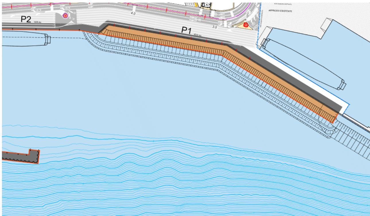
**Descrizione:** Area con fondale minimo di 9 m per garantire l'accesso delle navi al bacino interno. L'ampiezza dell'imboccatura è di circa 470 m.
