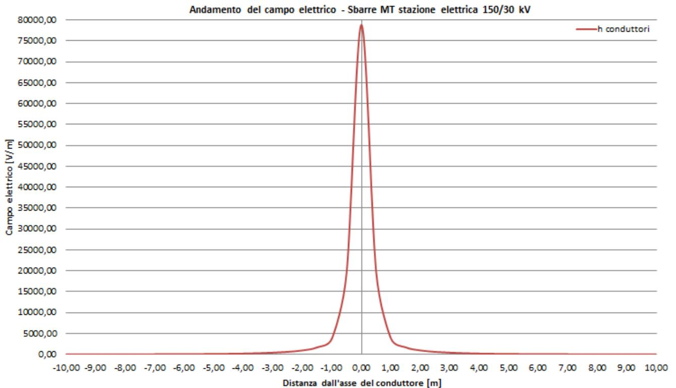
Figura 9: Andamento del campo elettrico in forma grafica - Cabina MT in stazione elettrica 30/150 kV.
