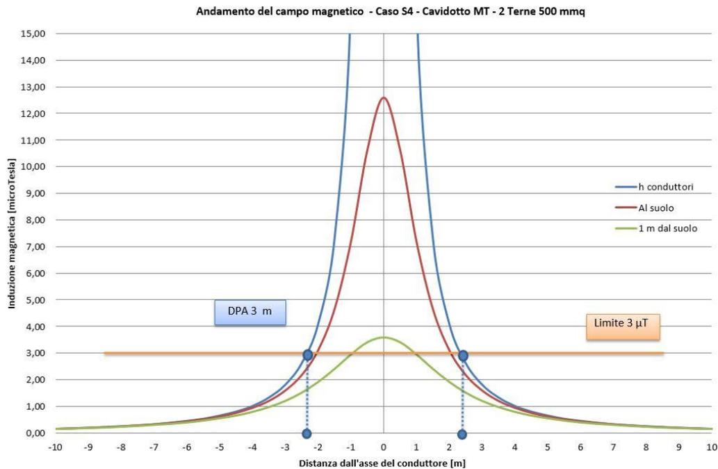
Figura 3: Andamento del campo magnetico in funzione della distanza dall’asse dei conduttori in forma grafica relativa alla simulazione.
