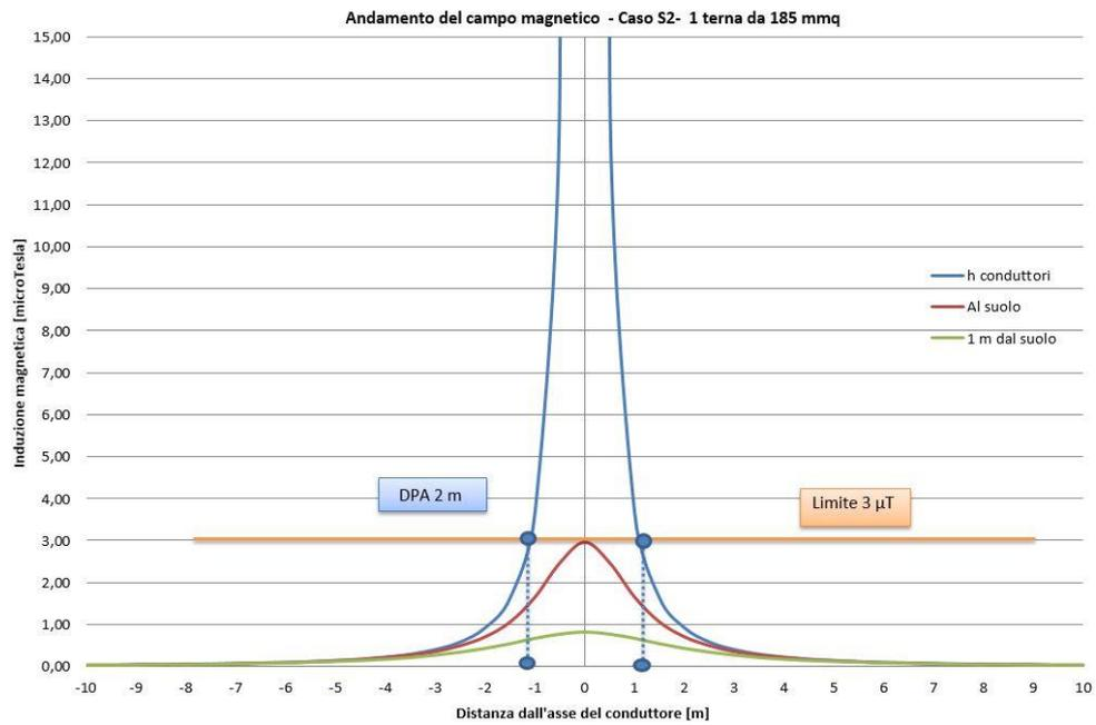
Figura 1: Andamento del campo magnetico in funzione della distanza dall’asse dei conduttori in forma grafica relativa alla simulazione.
