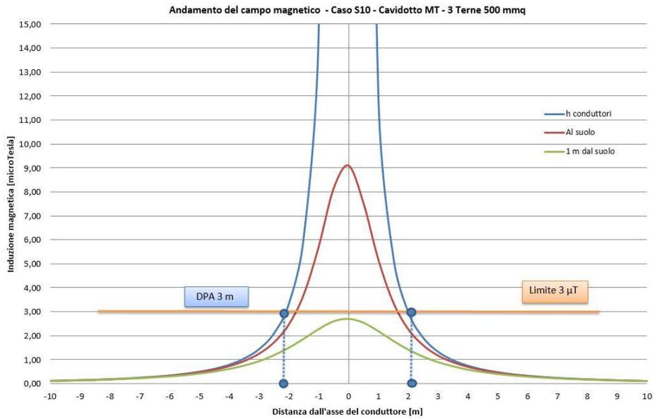
Figura 5: Andamento del campo magnetico in funzione della distanza dall’asse dei conduttori in forma grafica relativa alla simulazione.
