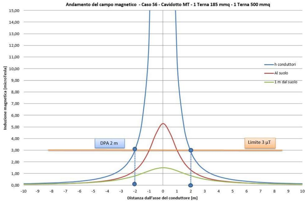
Figura 4: Andamento del campo magnetico in funzione della distanza dall'asse dei conduttori in forma grafica relativa alla simulazione.
