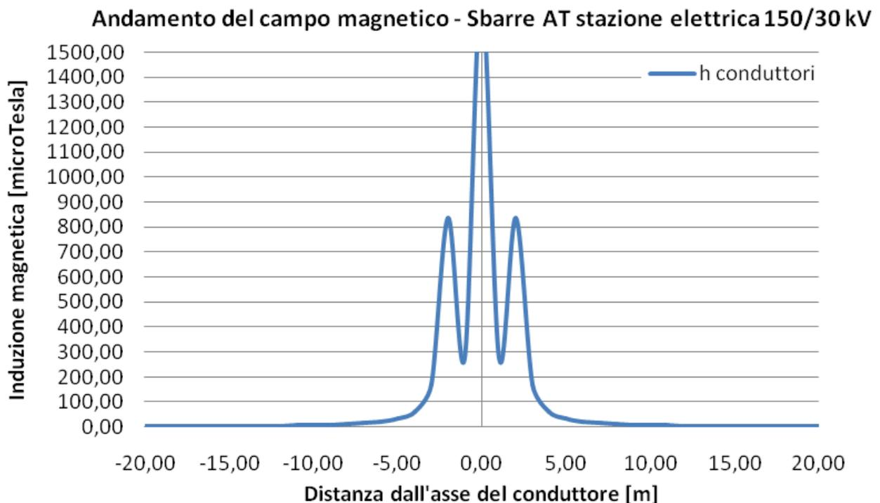
Figura 6: Andamento del campo magnetico in funzione della distanza dall'asse dei conduttori in forma grafica - Sbarre AT stazione elettrica 30/150 kV - Valutazione della Distanza di prima Approssimazione.
