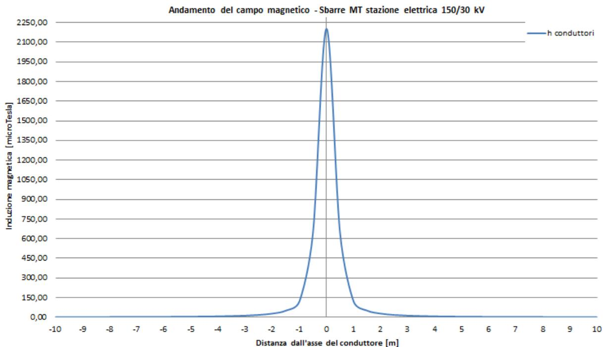
Figura 7: Andamento del campo magnetico in funzione della distanza dall'asse dei conduttori in forma grafica - Sbarre MT stazione elettrica 30/150 kV - Valutazione della Distanza di prima Approssimazione.
