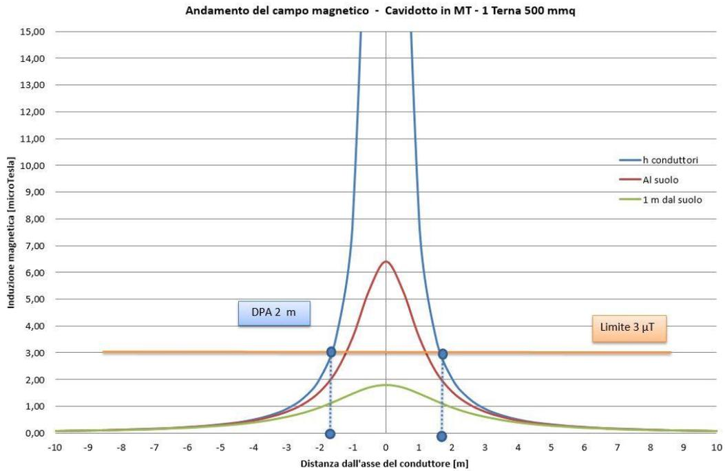
Figura 2: Andamento del campo magnetico in funzione della distanza dall’asse dei conduttori in forma grafica relativa alla simulazione.
