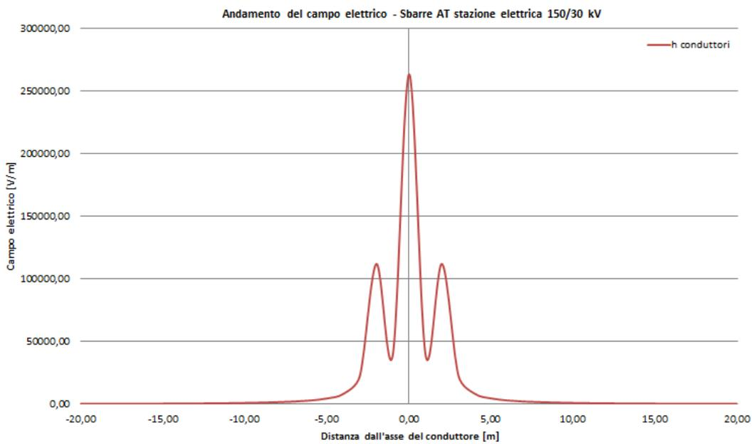
**Figura 8: Andamento del campo elettrico in forma grafica - Sbarre AT stazione elettrica 30/150 kV.**
