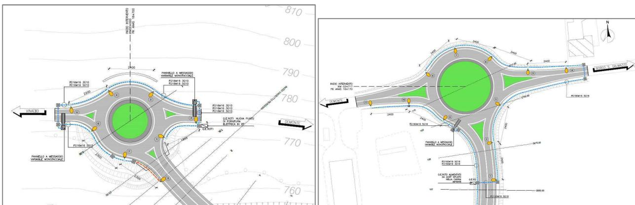
Figura 9 – Localizzazione pali LED in corrispondenza delle rotonde ovest (sx) ed est (dx) (particolare elaborati cod. T00IM00IMPLF07 e cod. T00IM00IMPLF08 allegati al progetto definitivo)
