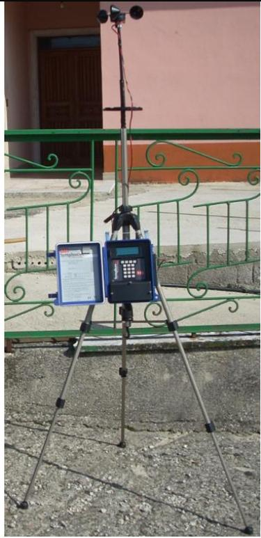
Figura 18: Stazione meteo portatile utilizzata- l'altezza di misura dei sensori è 1,5 m; Specifiche tecniche dell'NRG #40 Maximum caratteristiche tecniche DATA LOGGER
