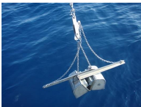
Fig. 2.5 – Benna Van Veen utilizzata per le indagini sulla comunità bentonica.
