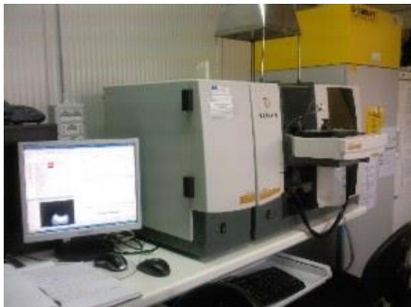
**A1-IX      VARIAN ICP-720ES per la misurazione di ALLUMINIO, BARIO, FERRO, CROMO, NICHEL, RAME, SILICIO, VANADIO, ZINCO, MANGANESE, MAGNESIO, TITANIO, GALLIO, ZIRCONIO e STAGNO**
