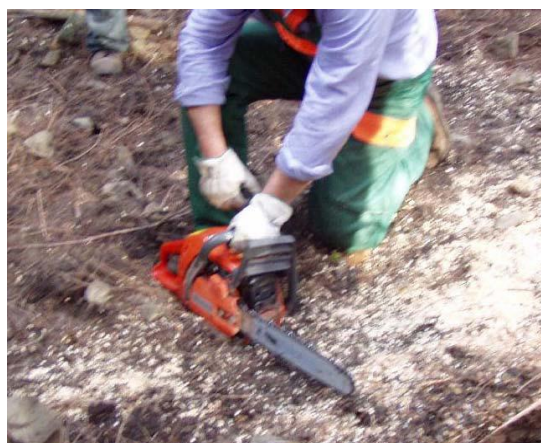
Avviamento della motosega eseguito in modo corretto
