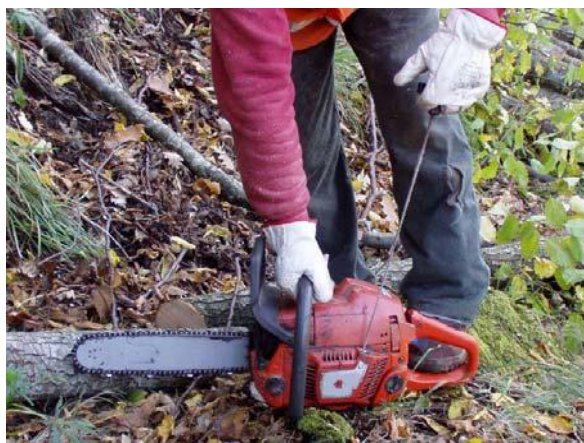
Avviamento della motosega eseguito in modo corretto
