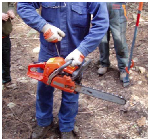
Avviamento della motosega eseguito in modo NON corretto
