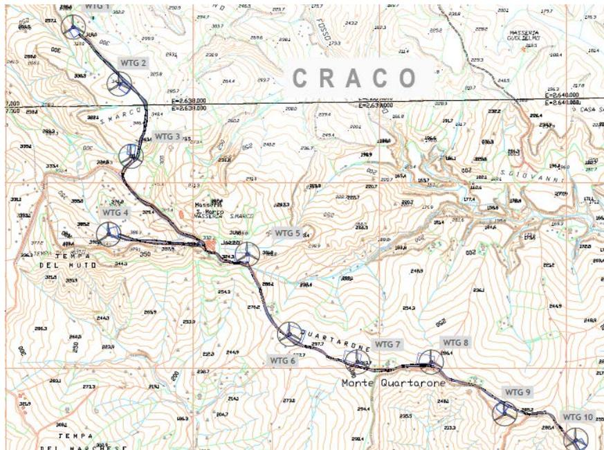
Figura 1: Layout autorizzato a 10 aerogeneratori su IGM 1:25000 - Determina Dirigenziale 23AF.2016/D00070 del 08/09/2016
