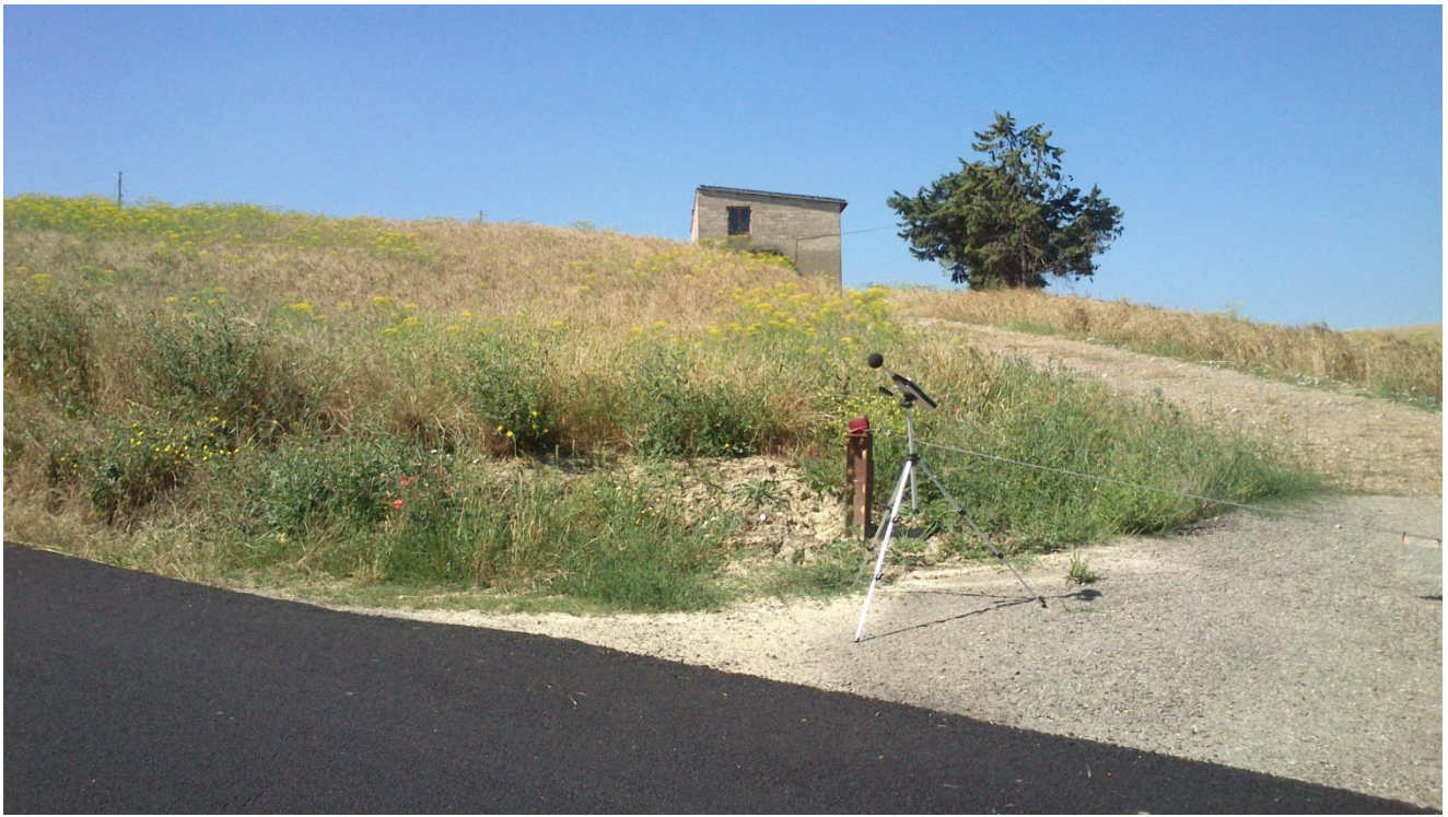
Figura 8: strada Statale 277 - diramazione verso Irsina - misura spot a bordo strada;
