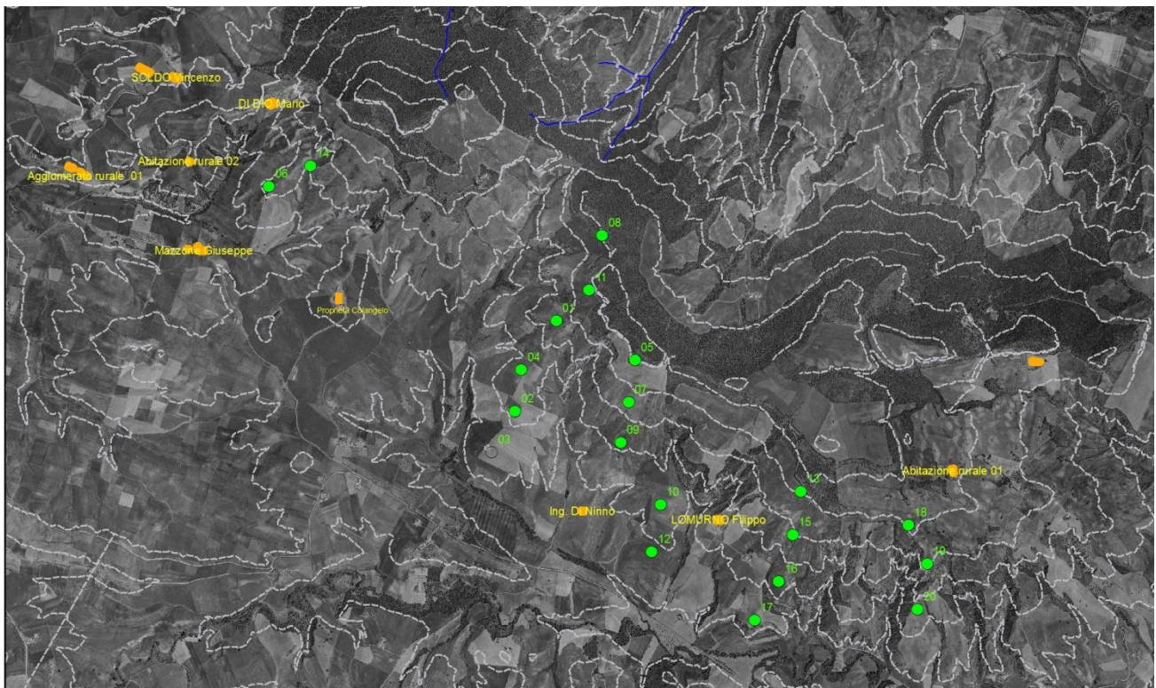
Figura 1: inquadramento generale dell'area interessata al Parco Eolico; in giallo sono indicati i ricettori e in verde la posizione delle turbine;
