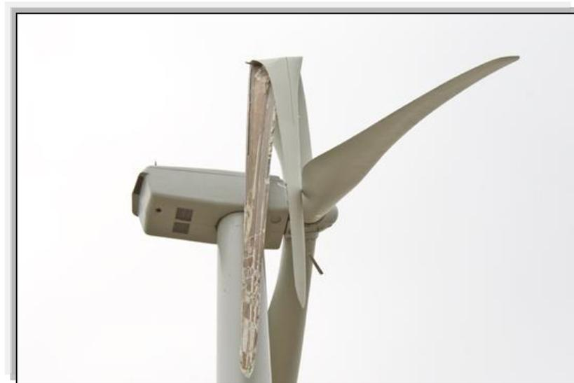
**Esempio di rottura pala senza distacco**
