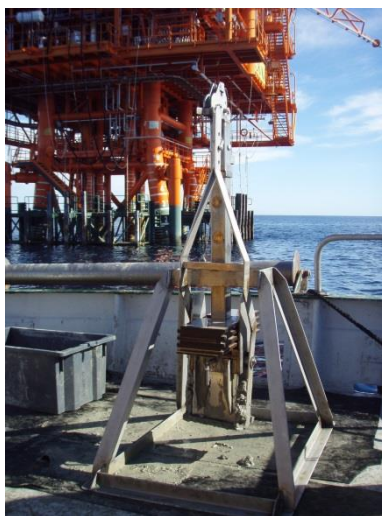
Fig. 2.4 – Box-corer utilizzato per le indagini fisiche e chimiche dei sedimenti.
