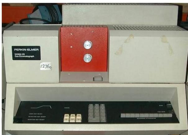
Il controllo interno della taratura dello strumento viene effettuato preliminarmente all'avvio di ogni indagine commissionata. Il controllo esterno e l'eventuale taratura ordinaria sono condotti annualmente da un Tecnico incaricato dalla Ditta costruttrice, quando il controllo interno risulta sfavorevole.
