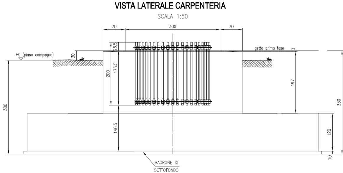
**Figura 15 -Disegno costruttivo di una fondazione superficiale tipo plinto a monoblocco per un sostegno monostelo**
