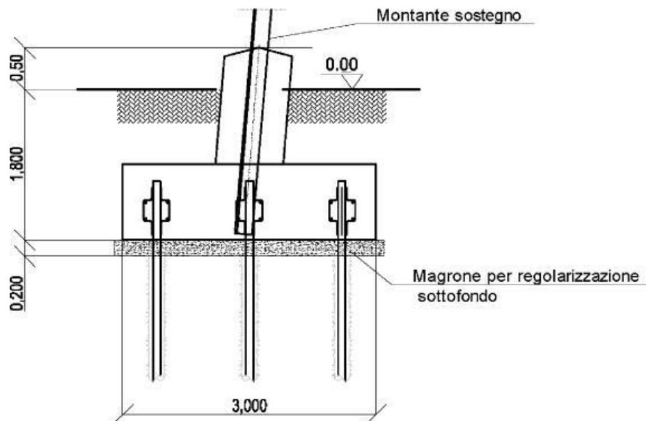
**Figura 23 - Disegno costruttivo di un micropalo**
