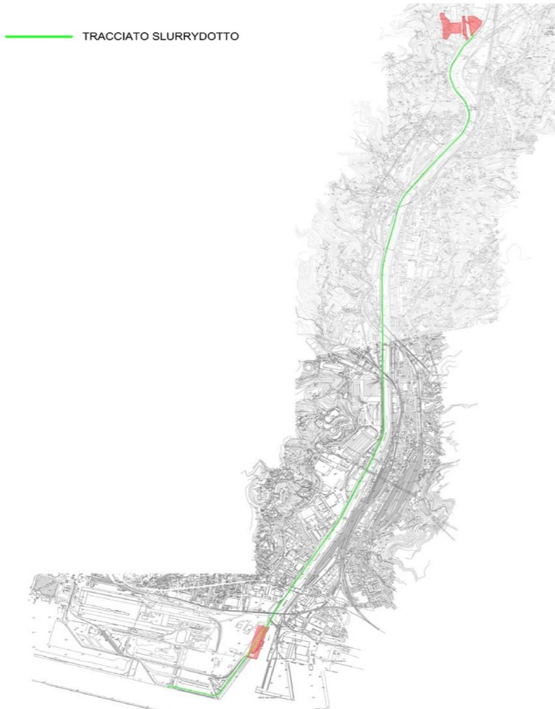
Il circuito di slurry previsto da progetto si sviluppa per circa 8,8 km lungo il greto del torrente Polcevera (cfr. Figura 4) e consiste in due linee parallele:
