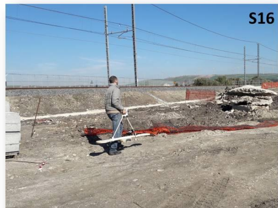
Figura 17 - Fasi di acquisizione dei dati elettromagnetici.
