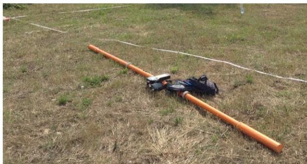
Figura 3: Elettromagnetometro CMD.
