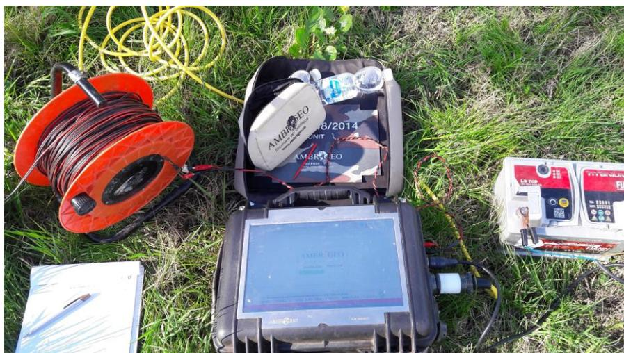
Figura 1: Sismografo digitale a 24 bit.
