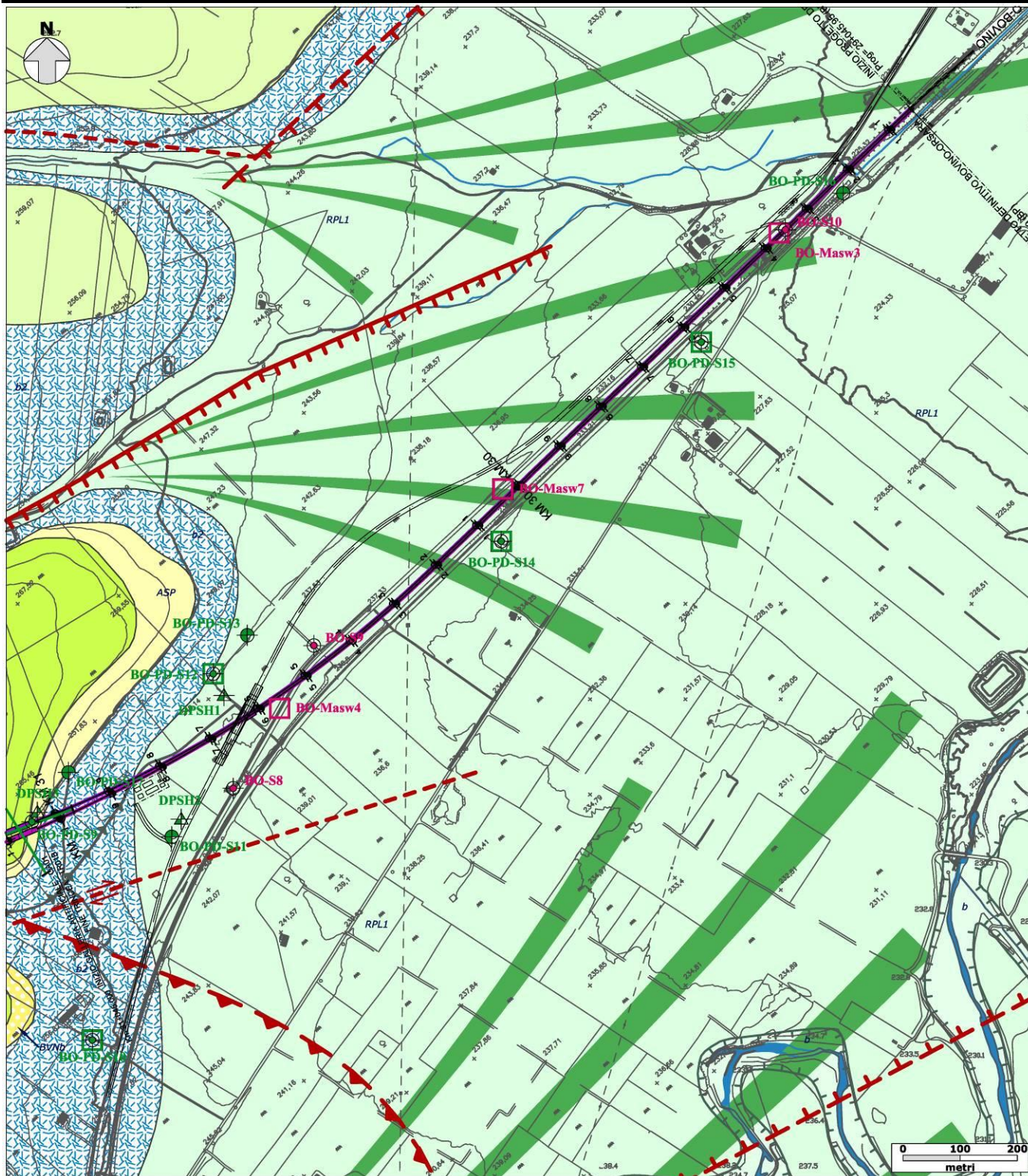
Figura 6. Stralcio della cartografia geologica per la tratta all'aperto di Bovino (scala 1:10.000).
