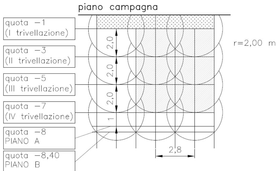
L'equidistanza tra le perforazioni è di 2.80 mt, mentre il raggio di efficacia è di 2.00 mt. Le sovrapposizioni che ne risultano sono inevitabili per ottenere la totale copertura della superficie da bonificare.
