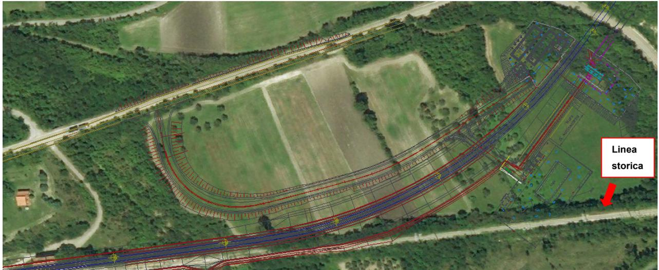
Figura 3 – Orsara - Configurazione planimetrica del raccordo tra la linea ferroviaria di progetto e la linea storica esistente (NV03)
