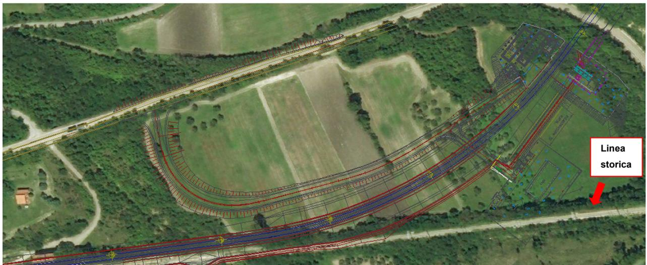
Figura 3 – Orsara - Configurazione planimetrica del raccordo tra la linea ferroviaria di progetto e la linea storica esistente.
