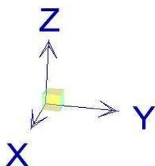
Il sistema di riferimento viene assunto con origine sul ciglio interno dell'impalcato, coincidente con il valore di ascissa  $x=0$  del modello. La disposizione degli assi segue la "regola della mano destra":
