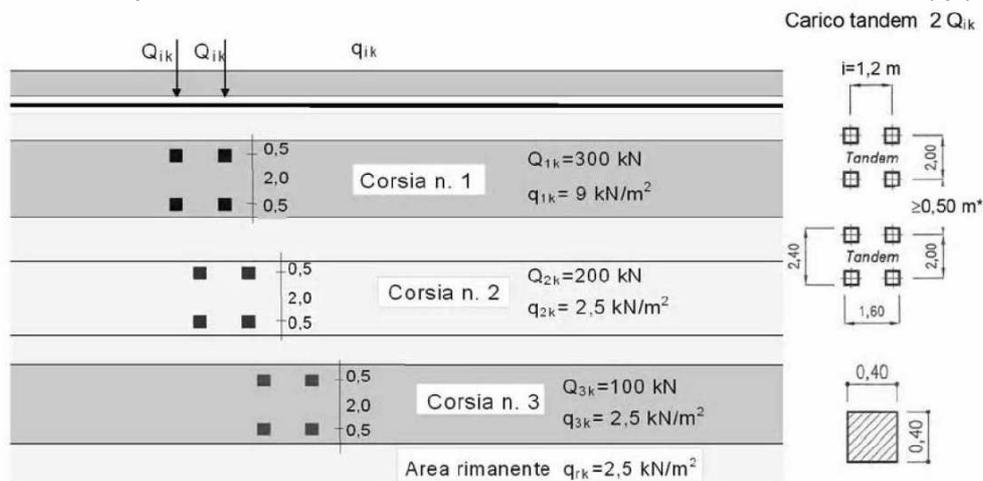
Tale schema è da assumere a riferimento sia per le verifiche globali sia per le verifiche locali, considerando un solo carico tandem per corsia disposto in asse alla corsia stessa. Il carico tandem, se presente, va considerato per intero.
