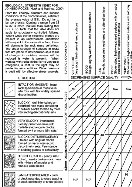
Fig. 17: Sistema di classificazione GSI (Geological Strength Index) nell'ultima versione di Hoek e Marinos (2000)
