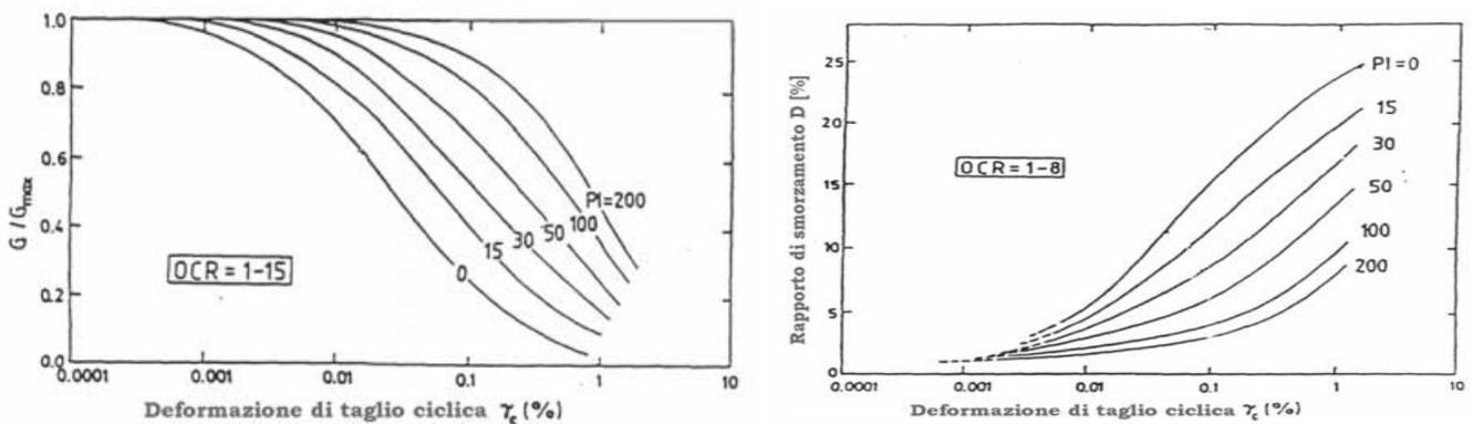
Fig. 2: Curva di decadimento del modulo di taglio  $G/G_0-\gamma$  e curva di smorzamento  $D-\gamma$  per terreni coesivi (Vucertic e Dobry, 1991).
