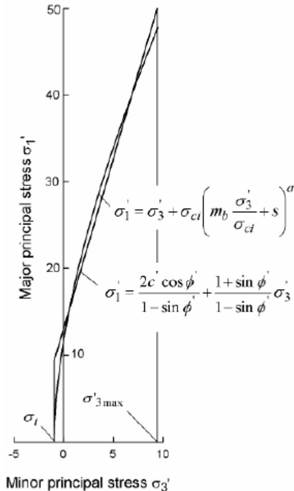
Fig. 20: Relazione fra gli sforzi principali massimi e minimi per il criterio di Hoek-Brown e per quello equivalente di Mohr-Coulomb.
