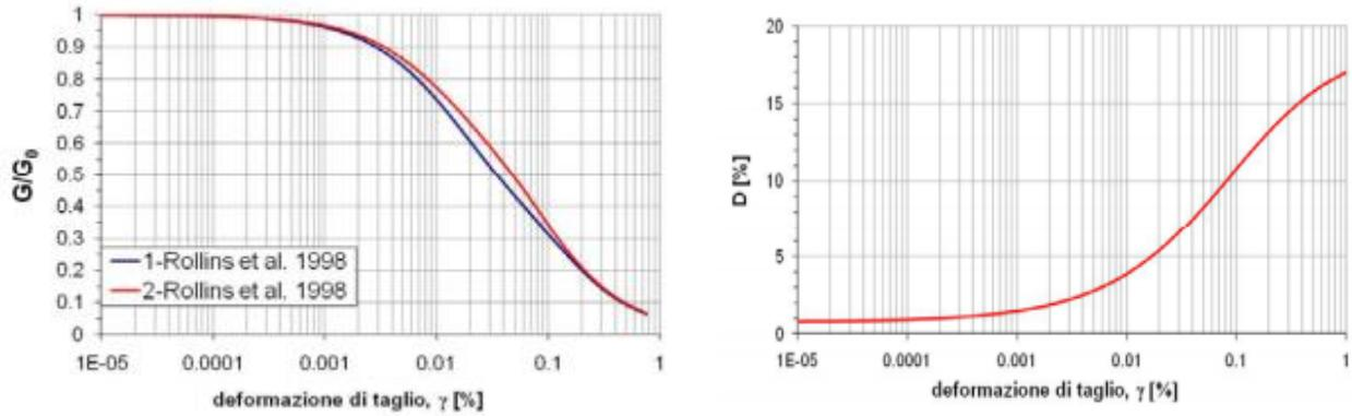
Fig. 4: Curva di decadimento del modulo di taglio  $G/G_0-\gamma$  e curva di smorzamento  $D-\gamma$  per ghiaie (Rollins et al., 1998).
