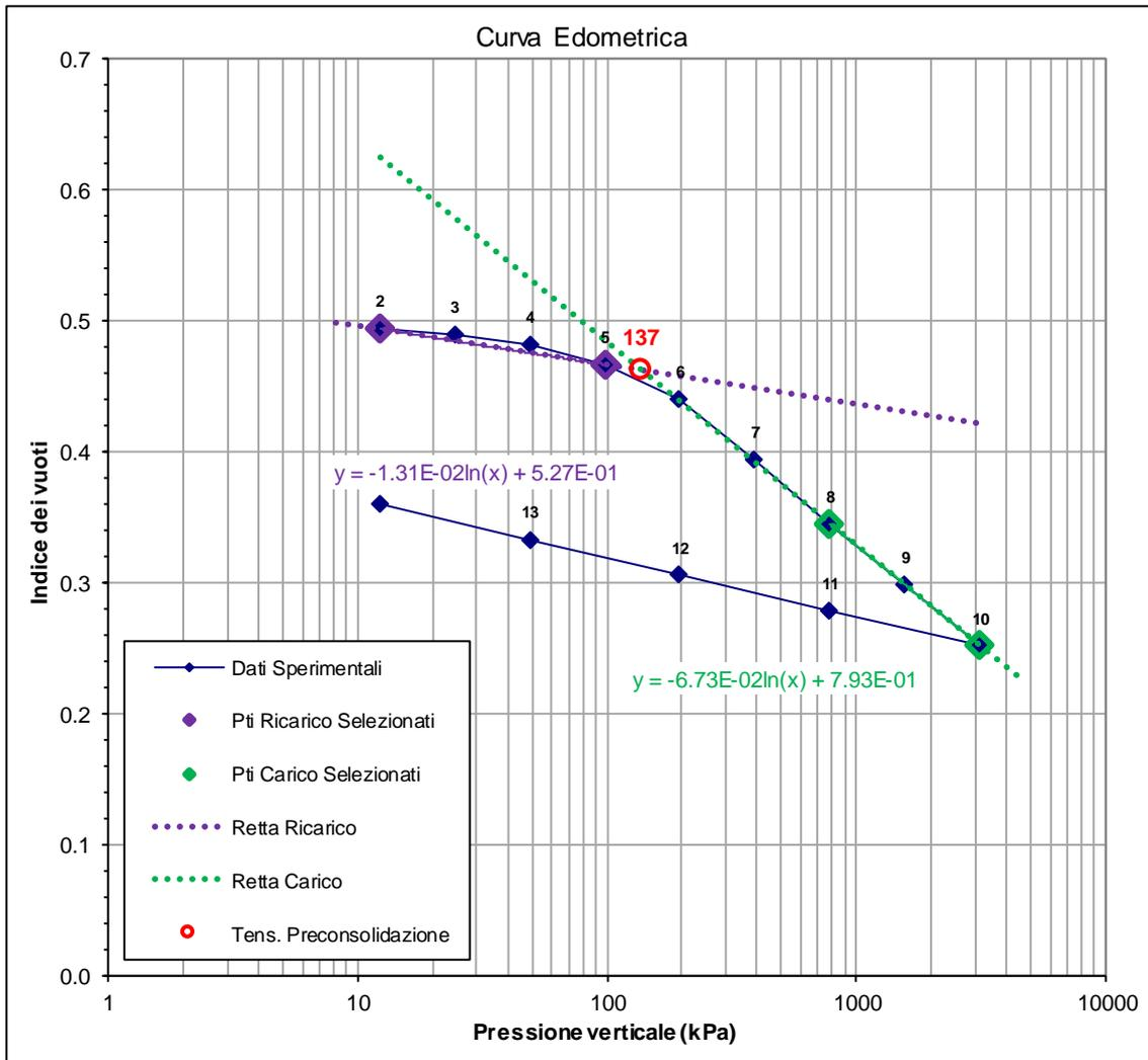
Fig. 9: Esempio di interpretazione della prova edometrica
