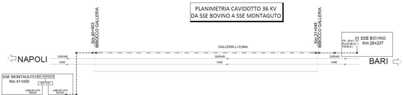
Figura 1 – Cavidotto tra la SSE Bovino e la SSE Montaguto
