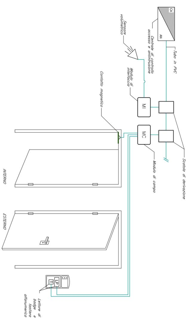
INSTALLAZIONE TIPO COMPONENTI IMPIANTO ANTINTRUSIONE
