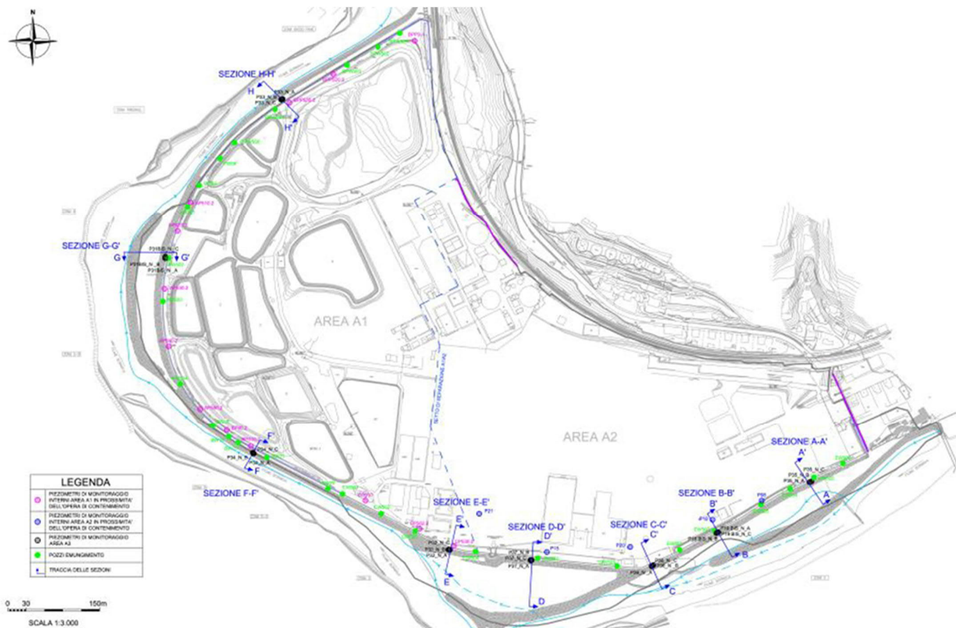
Figura 10: Sezioni “as-built” delle opere di contenimento, di riferimento per le verifiche di filtrazione (modelli di dettaglio)
