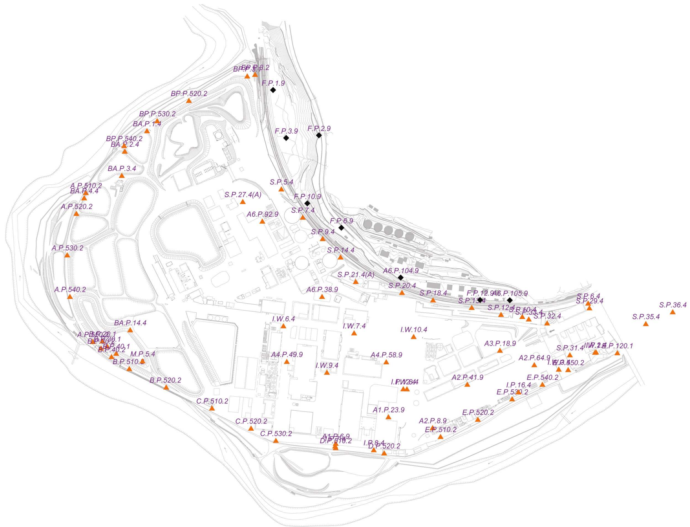
Figura 4: Piezometri stato attuale (zone A1- A2 e zona Palazzo Rosso estate 2006), in particolare in nero i piezometri monitorati in continuo
