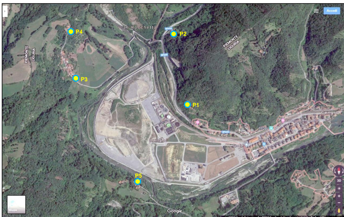
Figura 6 - Punti di misura fonometrica P1 ÷ P5
