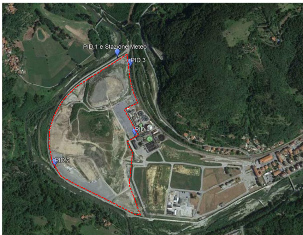
Figura 5-4: Ubicazione degli olfattometri (PID) e della centralina meteo in Zona A1. Il perimetro della Zona A1 è riportato in rosso.
