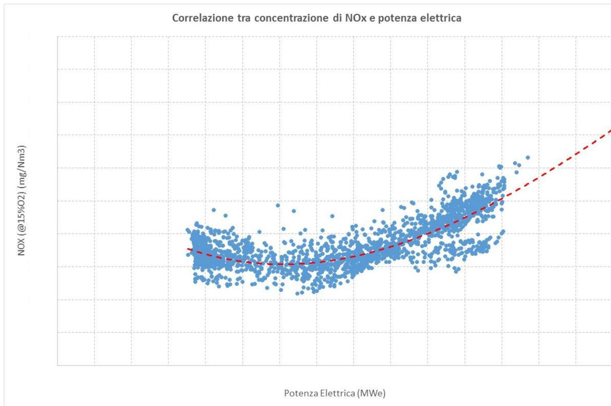
Fig.3a : Correlazione tra le emissioni NOx (mg/Nm<sup>3</sup>) e la potenza elettrica TG – periodo Aprile/Giugno 2017
