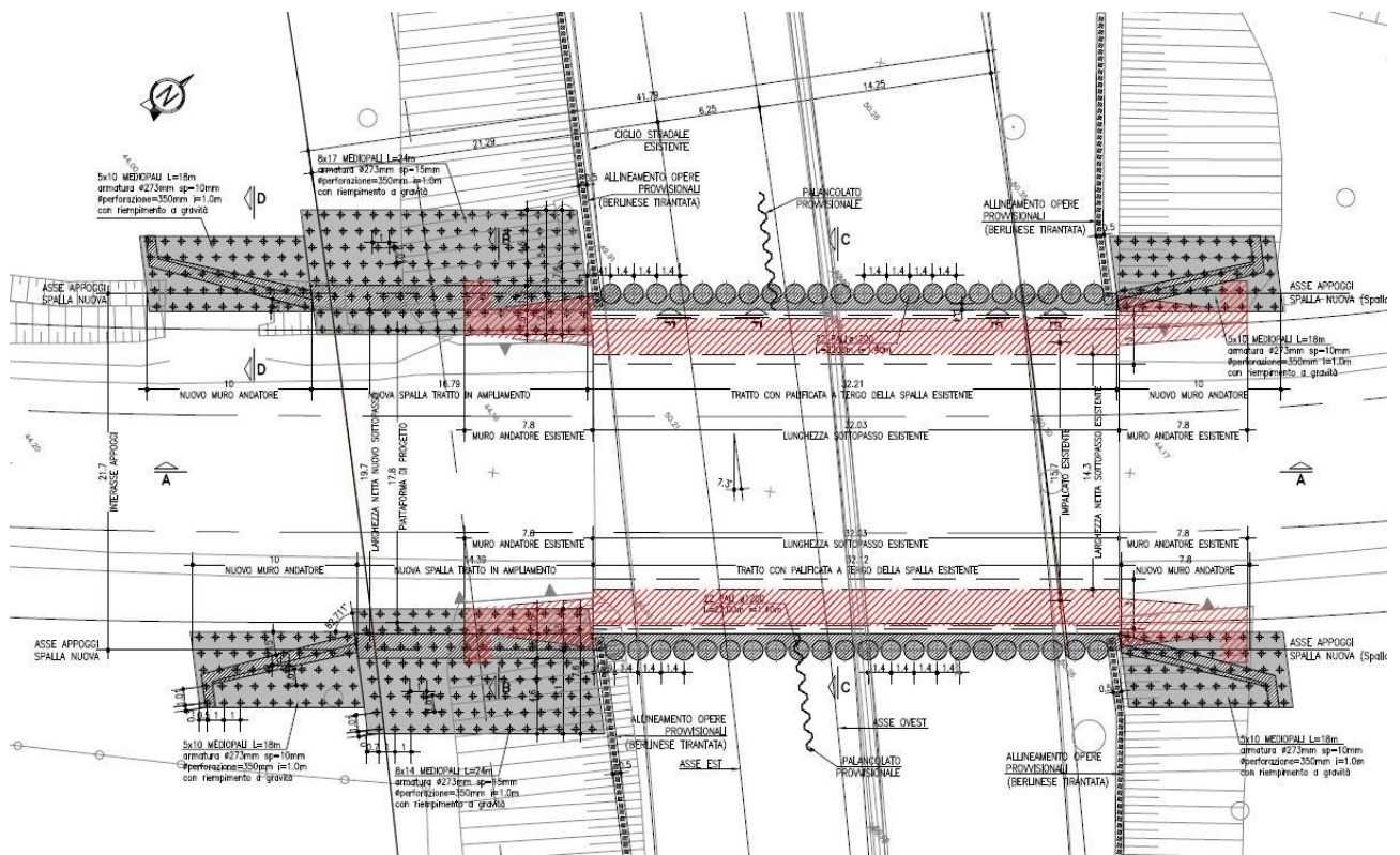
Fig. 2.2.6.3 – Planimetria di progetto opere di fondazione.
