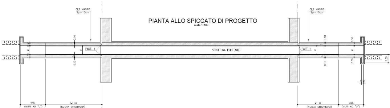
Fig. 2.4.2 – Prolungamento di tombini idraulici a raso in calcestruzzo armato realizzato in opera: sezione longitudinale a); planimetria b).
