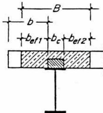
I valori  $b_{ei}$  devono essere moltiplicati per i coefficienti  $\eta$  secondo il prospetto 3.2.1 di CNR 10016, in funzione del rapporto  $b_{ei}/L$ , con L lunghezza di calcolo dell'opera.
