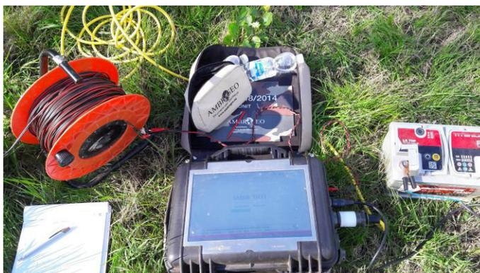
Figura 2: Sismografo digitale a 24 bit.
