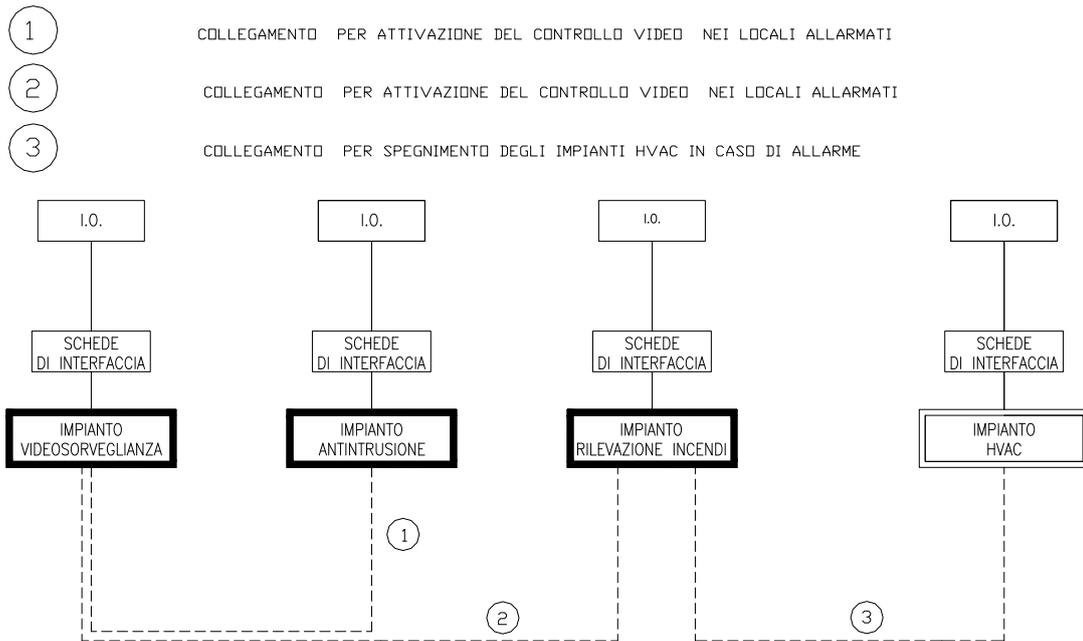
Per il collegamento con il sistema di supervisione la centrale TVCC dovrà essere dotata di apposita interfaccia e linguaggio di comunicazione basato su protocolli di comunicazione non proprietari.
