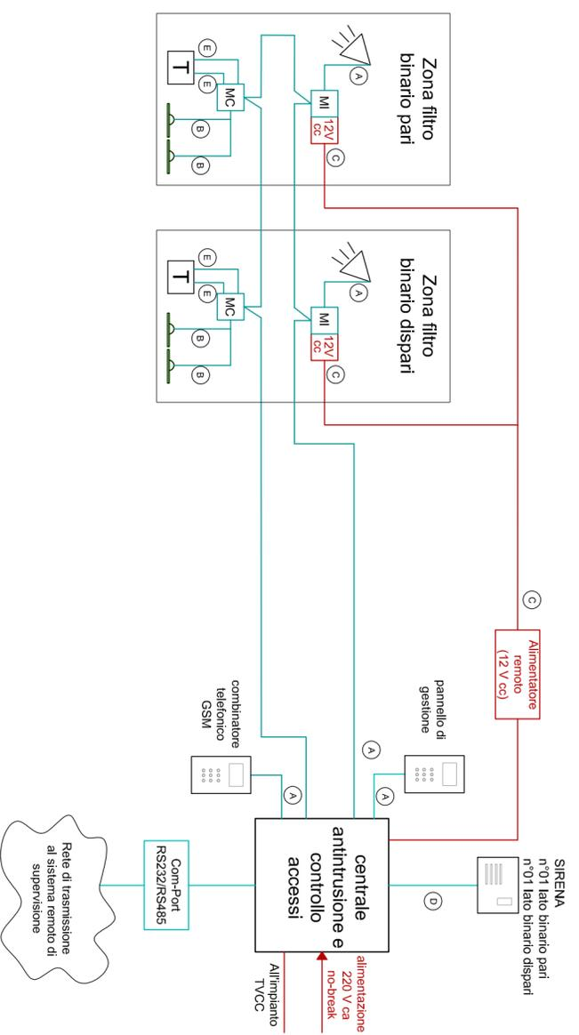
**INSTALLAZIONE TIPO COMPONENTI IMPIANTO ANTINTRUSIONE**
