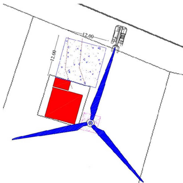
Layout di smontaggio del rotore di una turbina Vestas Modello V52
