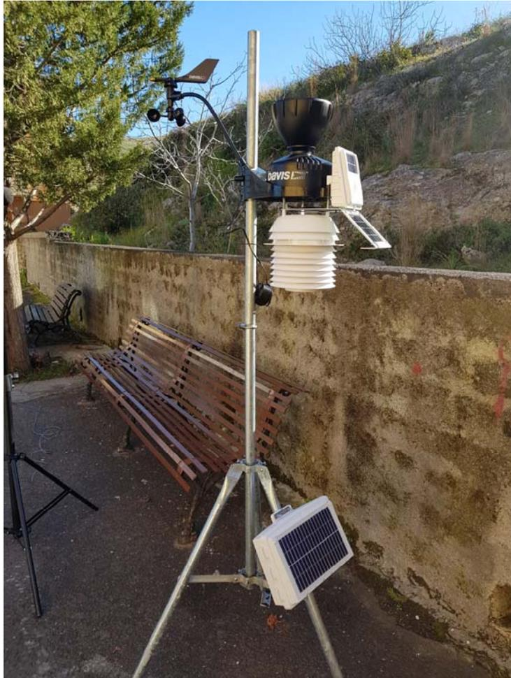
Stazione meteorologica Davis Vantage Pro2 wireless ventilata con blocco sensori integrato:
