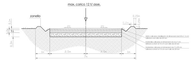
Sezione stradale tipo con scarpata (mezza costa) scala 1:50
