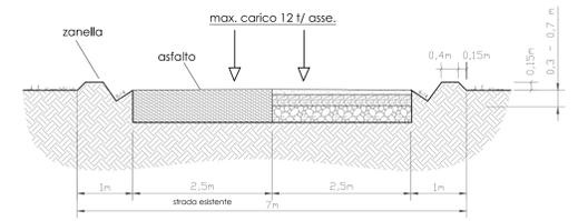
Sezione stradale tipo in scavo scala 1:50
