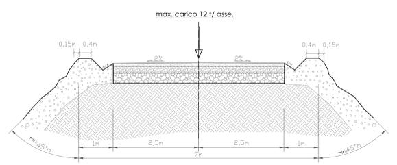
Sezione stradale tipo nel caso di allargamento della sede stradale esistente scala 1:50
