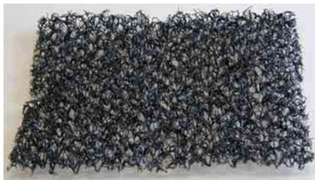
*Esempio di struttura di geostuoia*
