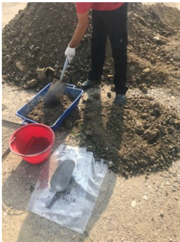
Fig. 5: omogeneizzazione del campione.
