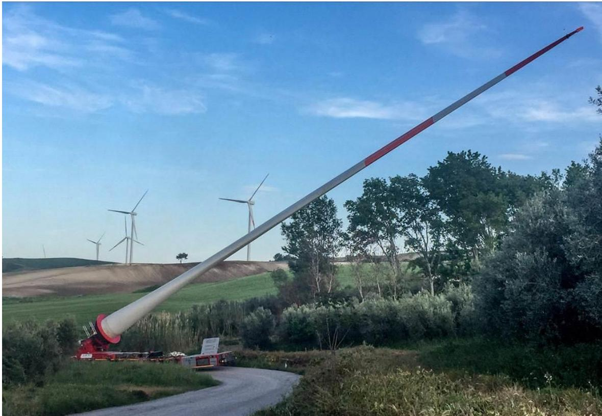
**Figura 12** - Esempio di utilizzo del bladelifter
