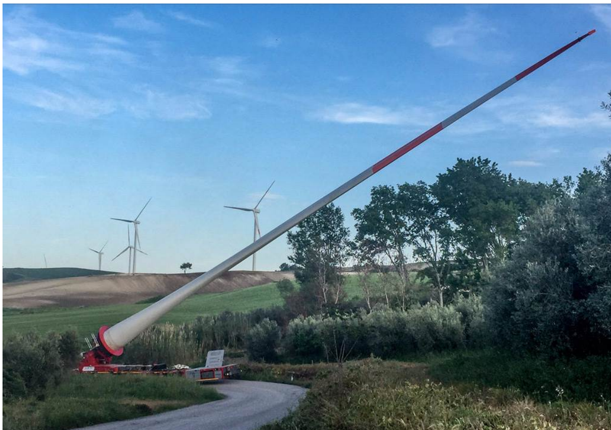
Figura 3: immagine del mezzo di trasporto eccezionale “blade lifter”
