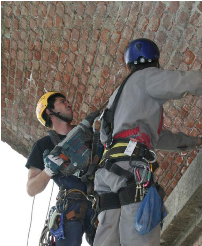
Fasi di esecuzione della prova con martinetto piatto M5
