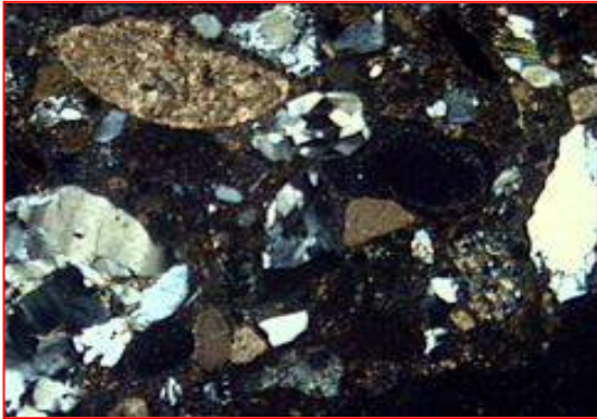
Luce trasmessa Nicol +; 70x al vero Visione generale della sezione. La matrice tra appare estinta.
