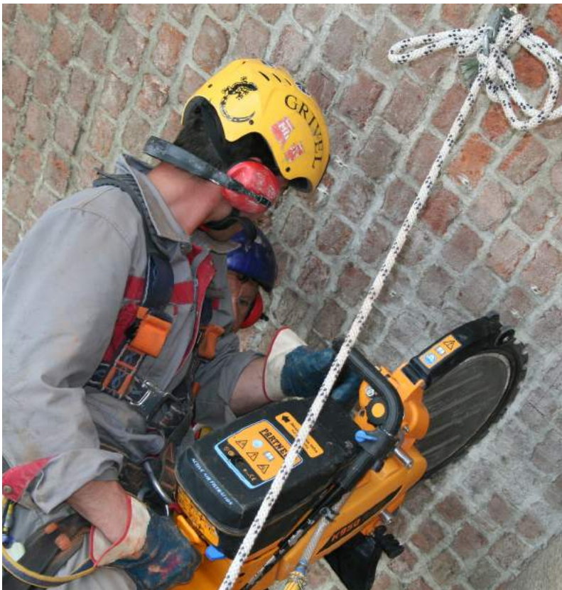
Fasi di esecuzione delle prove con martinetti piatti M1 e MD1
