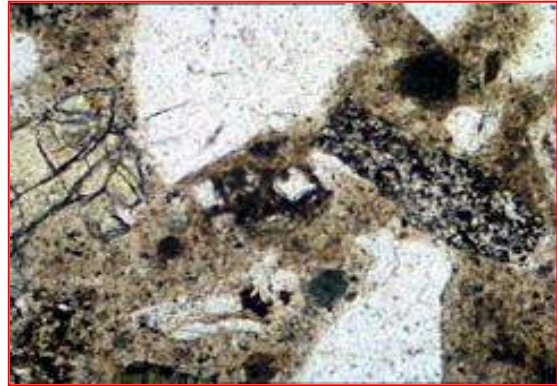
Luce trasmessa Nicol //; 270x al vero Granuli di cemento non reagito.
