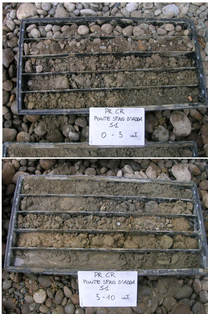
Fig. A2.1 – Campioni prelevati nei pressi di una pila di ponte nell'agosto 2015 (fonte: Provincia di Cremona)
