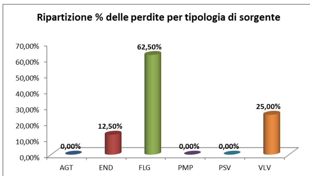
AGT: Agitatori; END: Fine linea; FLG: Flange; PMP: Pompe; PSV: Valvole di Sicurezza; VLV: Valvole
