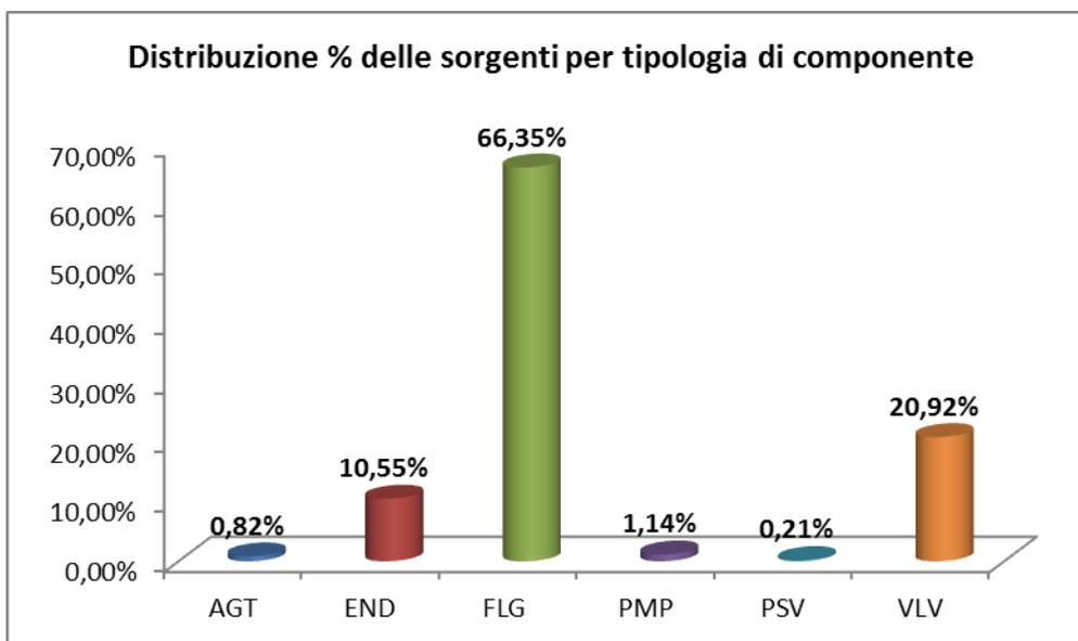
AGT: Agitatori; END: Fine linea; FLG: Flange; PMP: Pompe, PSV: Valvole di Sicurezza; VLV: Valvole
