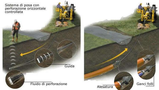
Fig. 1.3 – Posa in opera tubazione per alloggio cavi
