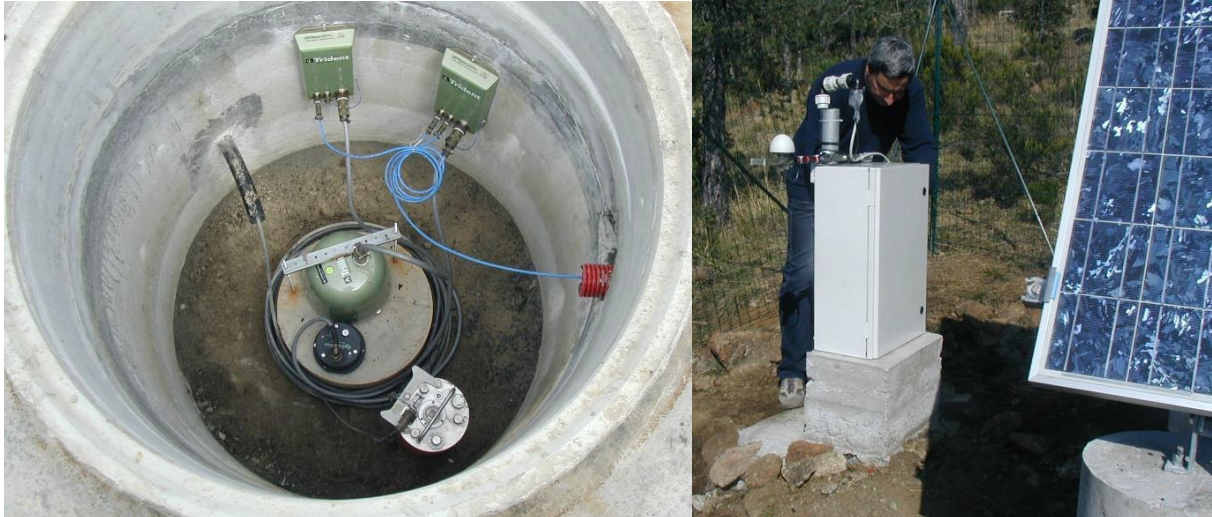
Figura 33: Esempio di stazione sismica superficiale
